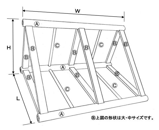
$\bigcirc A \phi 80 \times 5.0t$ アルミ丸パイプ
