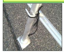
①使用時は、三脚の 後脚を上下左右に 振らないよう最下段 をヒモ等で固定し 収納してください。 なお、首振りタイプに ついては特に注意 してご使用ください。
